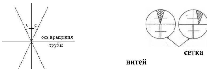
Рис. 3 Определение коллимационной погрешности:
