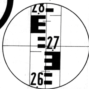
Поле зрения зрительной трубы нивелира Н-10КЛ
