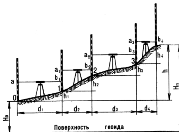
Рис. 17. Схема последовательного нивелирования.
