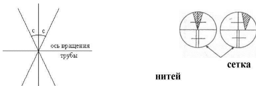
Рис. 3 Определение коллимационной погрешности:
