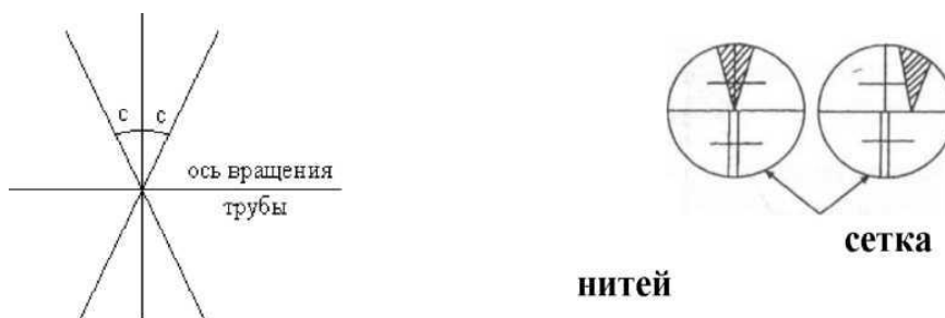
Рис. 3 Определение коллимационной погрешности:
