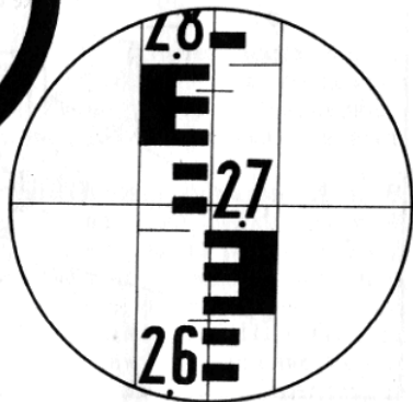
Поле зрения зрительной трубы нивелира Н-10КЛ
